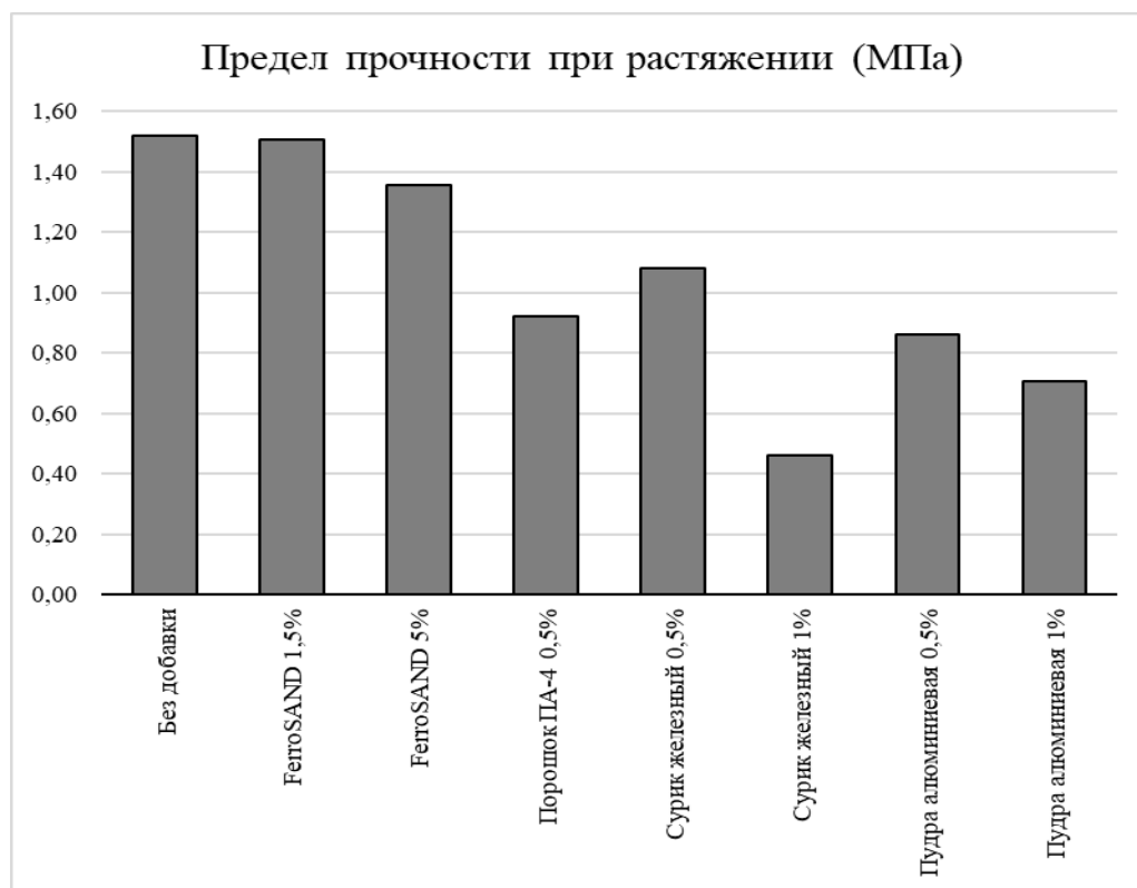
Рис. 1. Сравнительные результаты испытаний на предел прочности при растяжении
